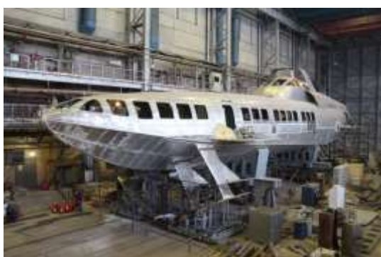
Строительство и спуск на воду морского судна на подводных крыльях нового поколения «Комета-120М»
